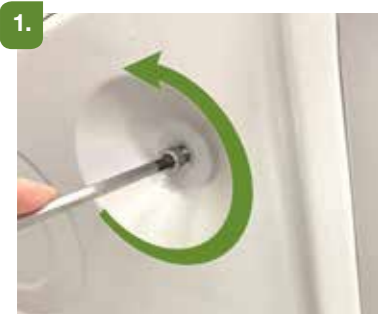
1. Откройте кожух ременного привода, повернув ручку против часовой стрелки.
