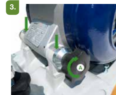
3. Закрепите двигатель, затянув ручку (A).
