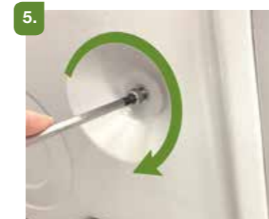
5. Установите кожух приводных ремней и затяните винт.
