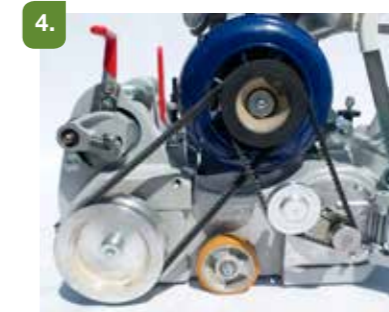
4. Установите и натяните приводные ремни.
